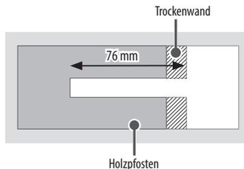
Verwenden Sie einen  $\varnothing 4$  mm Bohrkopf für Holz und eine Bohrtiefe von 76 mm. (Entfernen Sie die Bohrrückstände aus den Löchern.)
